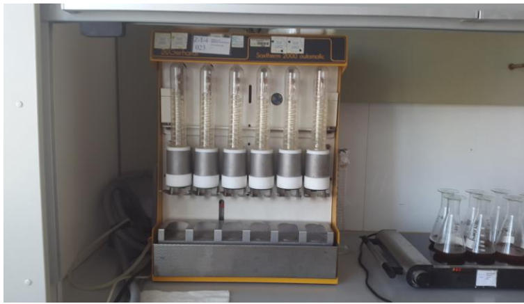
Slika 3.2.1.3. Uređaj za ekstrakciju, Soxtherm 2000 Automatic, Gerhardt
