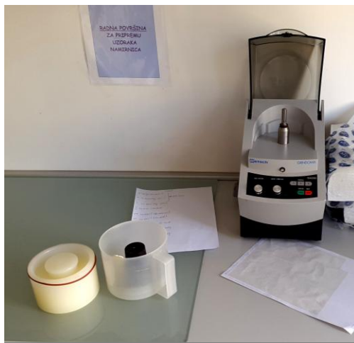
Slika 3.2.1.1 Uređaj za homogeniziranje, Grindomix GM 200, Retsch (foto: Sablić, 2015.)
