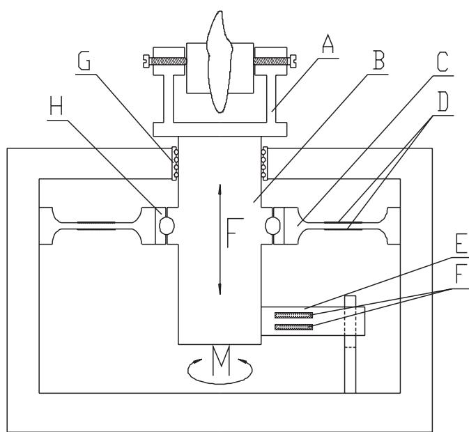
**Slika 1.** Shema uređaja za mjerjenje vertikalne sile, okretnog momenta i vremena: A – platforma nosača zuba, B – vertikalna osovina, C – membranski senzor, D – elektrooptorne mjerne trake za mjerjenje vertikalne sile, E – senzor torzije, F – elektrooptorne mjerne trake za mjerjenje okretnog momenta, G – radijalni ležaj, H – aksijalno-radijalni ležaj.
