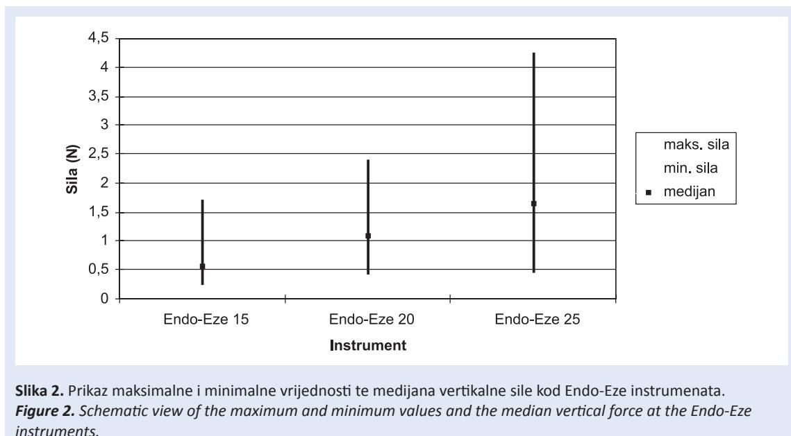
**Slika 2.** Prikaz maksimalne i minimalne vrijednosti te medijana vertikalne sile kod Endo-Eze instrumenata.
