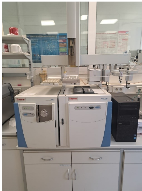
Slika 12 GC-MS/MS Thermo Trace 1300 GC + ISQ MS izvor:osobna kolekcija
