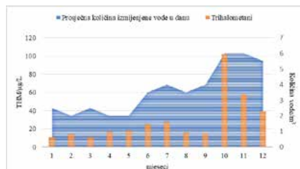
Slika 4: Koncentracije THM-a i količina izmijenjene količine vode u danu tijekom primjene kombinirane i jednostruke dezinfekcije bazenske vode
