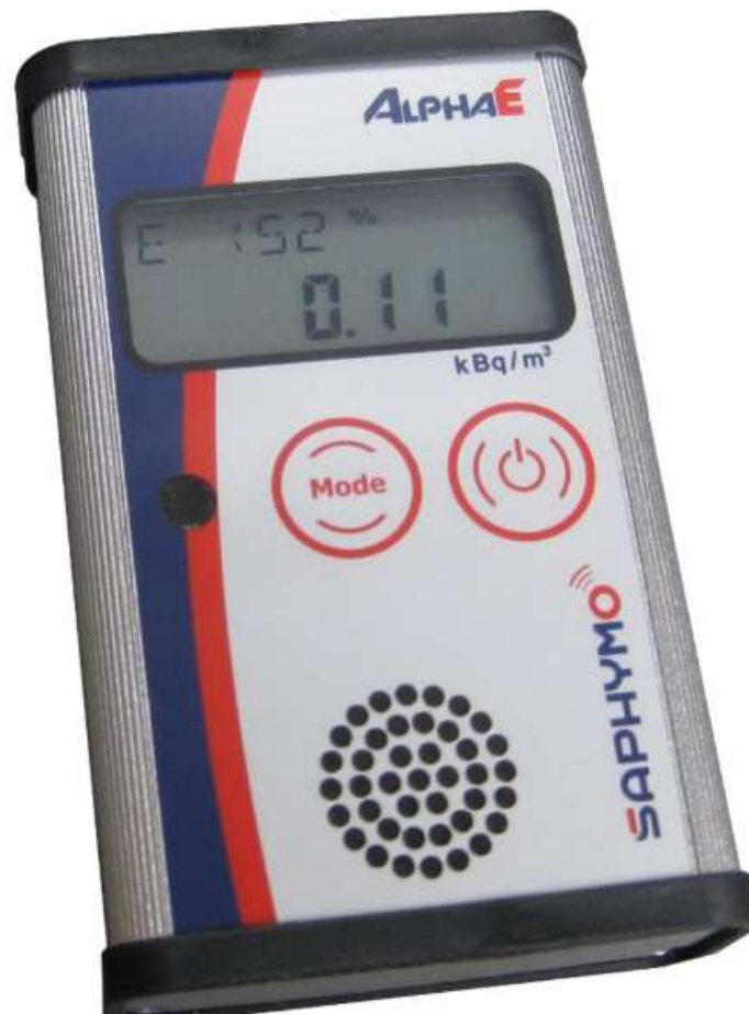
Slika 6. Prikaz AlphaE uređaja koji je korišten za mjerenje koncentracije radona.
