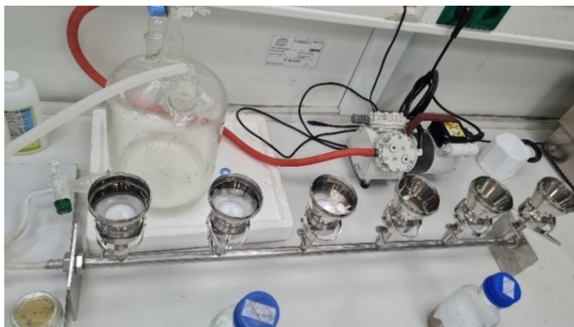
Slika 11. Aparatura za tehniku membranske filtracije (izvor: Odsjek za sanitarnu mikrobiologiju i biologiju okoliša NZZJZ PGŽ)
