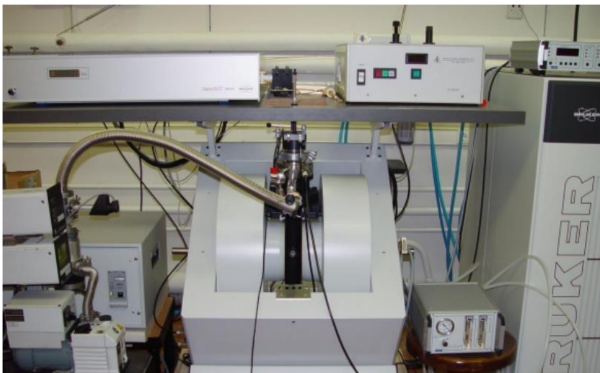
Slika 12. EPR spektrometar Bruker FT-EPR 850E.
