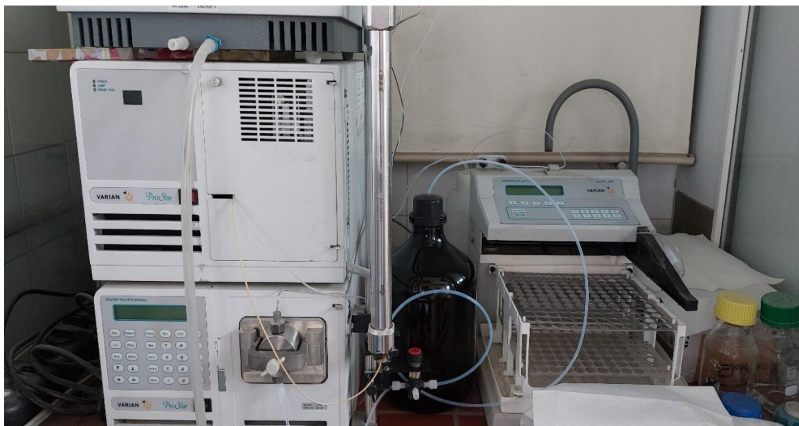
Slika 14. Prikaz instrumenta za gel permeacijsku tekućinsku kromatografiju; GPC (Varian, ProStar, Ujedinjeno Kraljevstvo); izvor: vlastita fotografija
