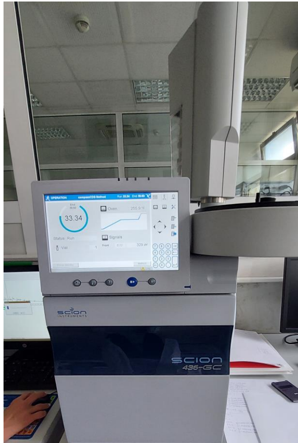
Slika 13. Prikaz instrumenta za plinsku kromatografiju s detektorom zahvata elektrona; GC-ECD (SCION 436-GC, Ujedinjeno Kraljevstvo); izvor: vlastita fotografija
