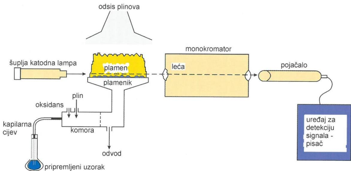
**Slika 7.** Prikaz načina rada atomskog apsorpcijskog spektrofotometra (15)
