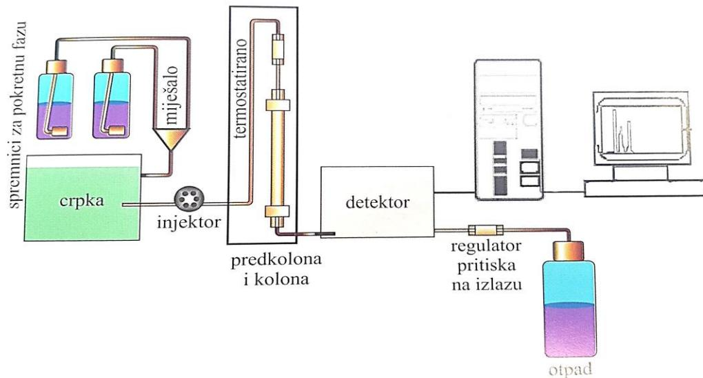
**Slika 11.** Shematski prikaz rada tekućinskog kromatografa visoke djelotvornosti (15)
