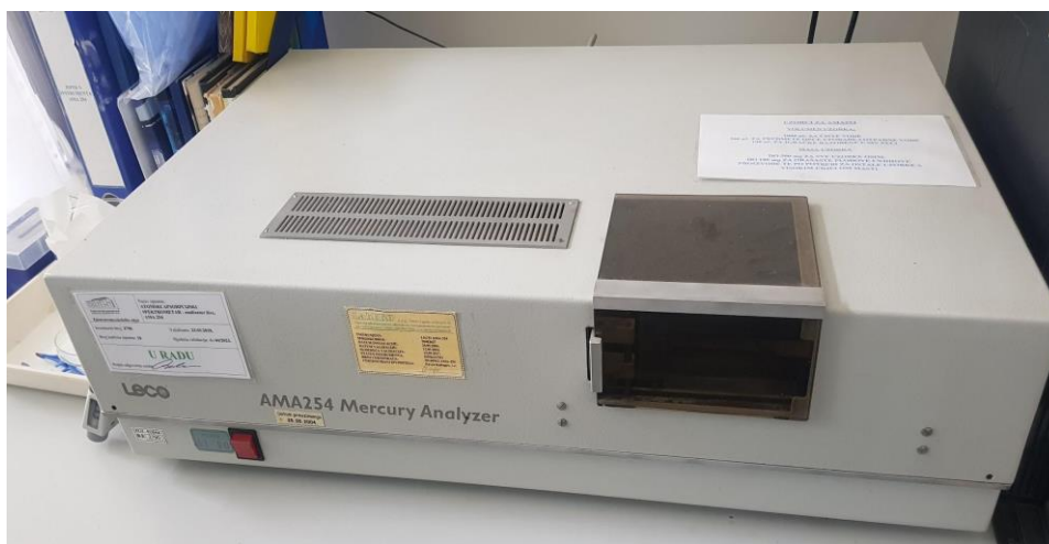
Slika 9. Analizator žive AMA254, Leco
