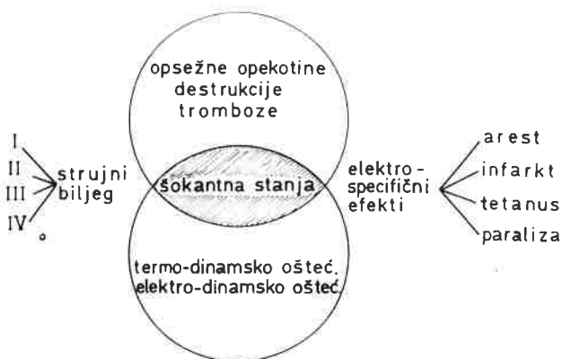
Pregledni prikaz oštećenja uslijed djelovanja električne struje.
