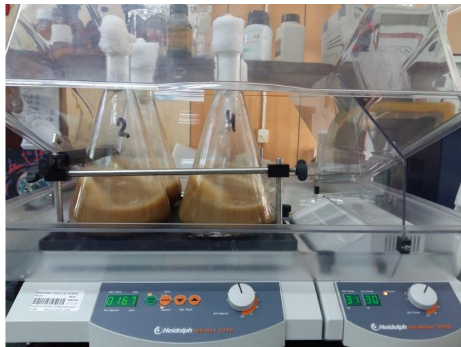
Slika 4. Tresilica za uzgoj kvasca
