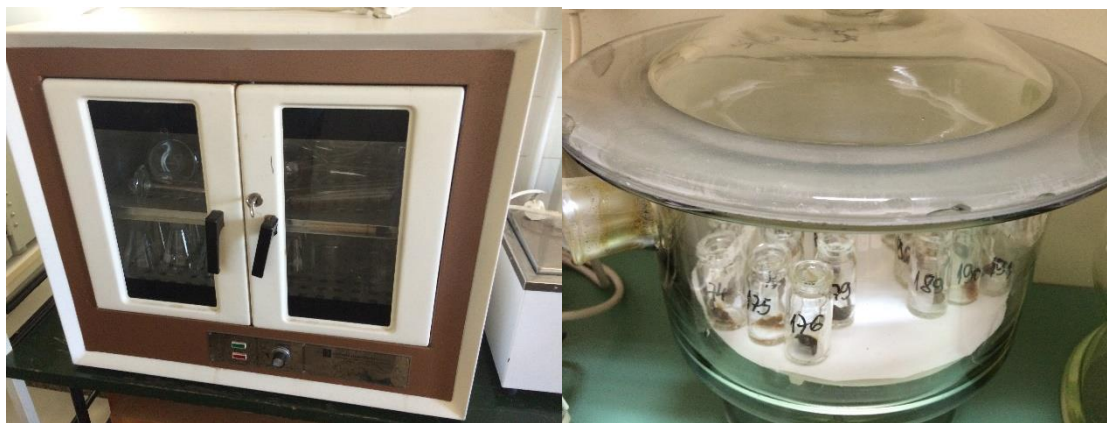
Slika 3. Lijevo je prikazan sušionik, a desno su prikazani uzorci pohranjeni u eksikatoru
