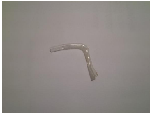
Slika 3: Degradirana cjevčica za slušni aparat (nakon uporabe).
