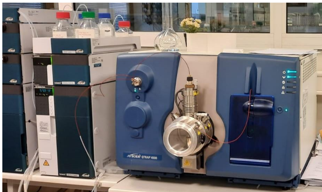
Slika 11. LC-MS/MS Ab sciex qtrap 4500, HPLC Sciex exion LC
