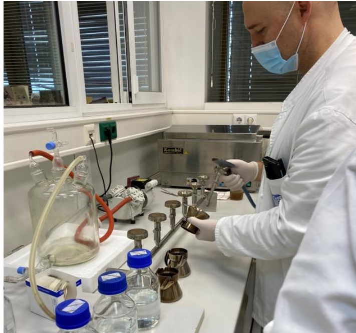
Slika 1. Postupak provođenja sterilizacije aparature pomoću plamena
