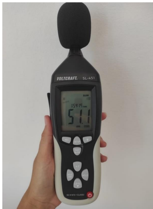
Slika 13. Uređaj koji smo koristili za mjerenje buke.
