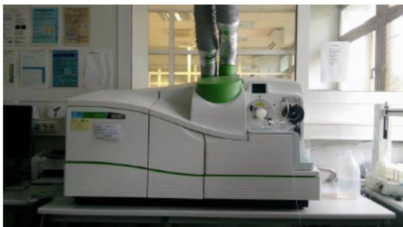
Slika 5. ICP-MS NexION 300x Perkin Elmer
