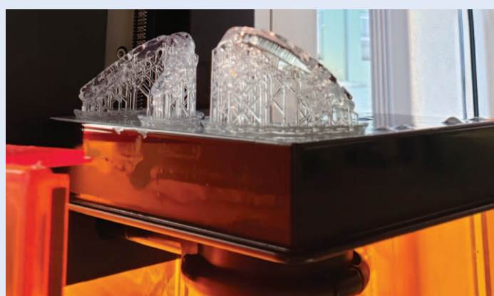
Slika 11. Printana pločica u 3D printeru
