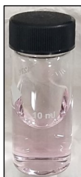
Slika 24. Kiveta za mjerenje rezidualnog klora
