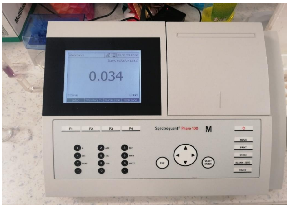
Slika 4. UV-VIS Spectroquant® Pharo 100, Merck, Darmstadt, Njemačka (Fotografija: Ela Mijatović).
