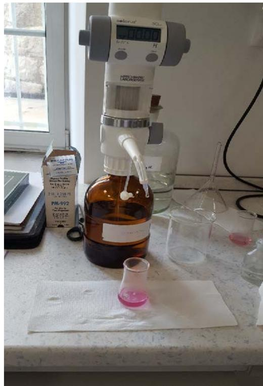
**Slika 9.** Automatsko titriranje suspenzije uzorka tla s NaOH
