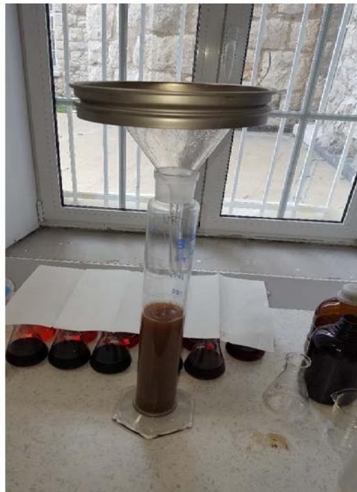
**Slika 4.** Prosijavanje uzorka tla kroz 0,2 mm sito u Novakov cilindar
