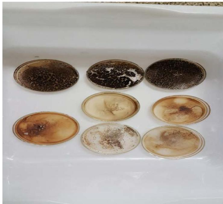
**Slika 6.** Uzorci tla nakon otparavanja u sušioniku
