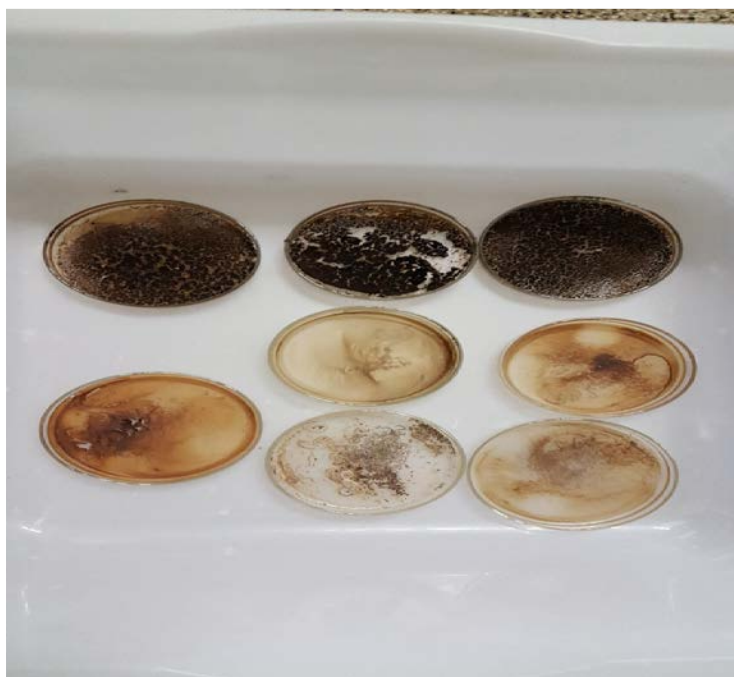
Slika 6. Uzorci tla nakon otparavanja u sušioniku
