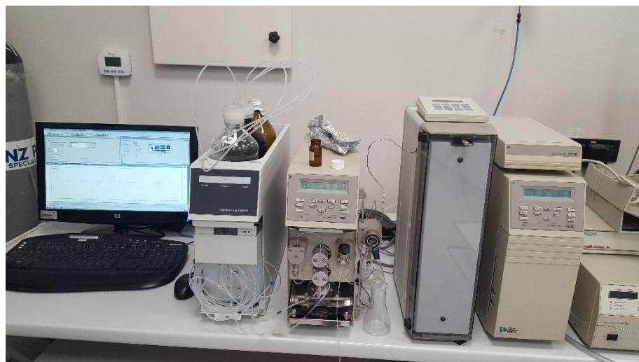
**Slika 15.** Visoko djelotvorna tekućinska kromatografija (HPLC)
