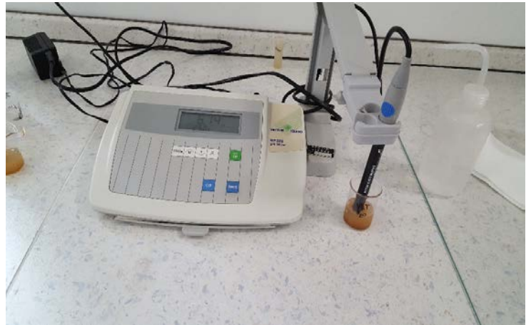
Slika 8. Mjerenje pH suspenzije tla pomoću pH-metra
