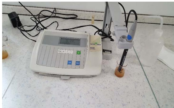
**Slika 8.** Mjerenje pH suspenzije tla pomoću pH-metra
