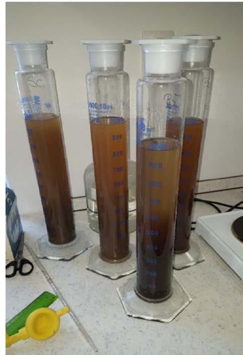
**Slika 5.** Uzorci tla u Novakovom cilindru
