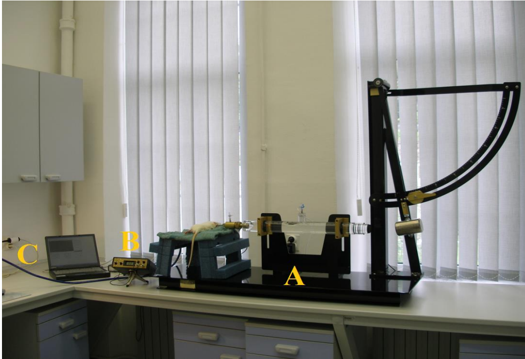
Slika 4. Sustav za LFP ozljedu u štakora: aparat za LFP ozljedu (A), osciloskop (B), računalo (C). Preuzeto uz dozvolu iz Pilipović K. Traumatska ozljeda mozga u štakora: mehanizmi oštećenja i oporavka te učinci pioglitazona i enoksaparina (2011).
