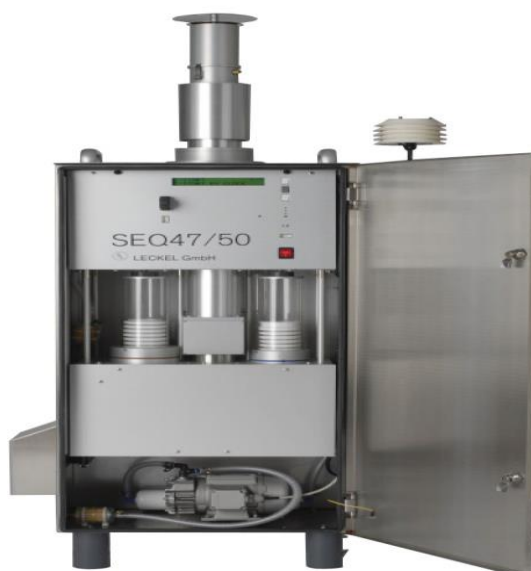
Slika 13. Uređaj na principu standardne gravimetrijske metode, SEQ 47/50 Sven Leckel
