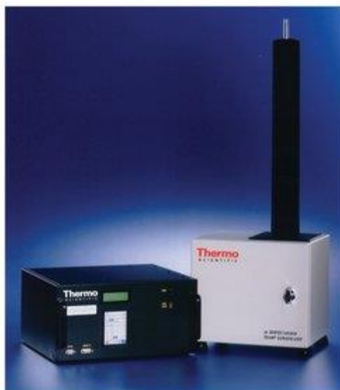
Slika 12. Automatski analizator TEOM 1400
