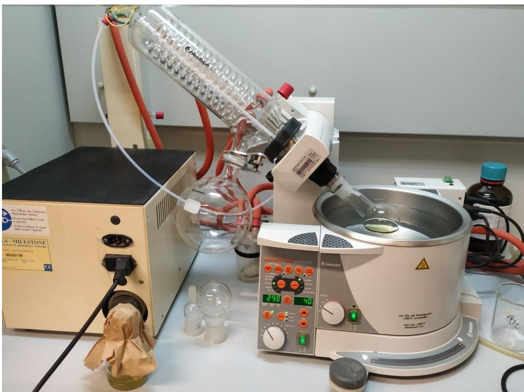
Slika 8. Ekstrakti na isušivanju u rotacijskom vakuumskom uparivaču
