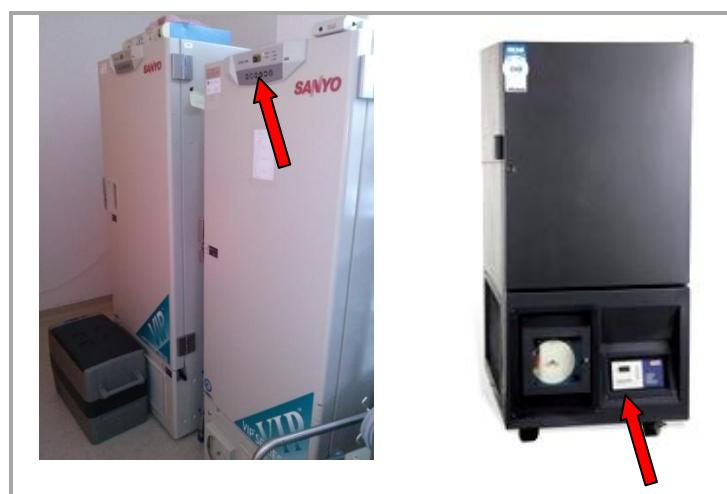
Slika 20. Stalna kontrola temperature zamrzivača i nadzor osoblja (očitavanje ispisa)
