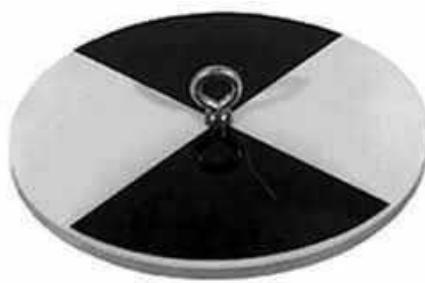
**Slika 3.Secchi disk za mjerjenje turbiditeta [19]**
