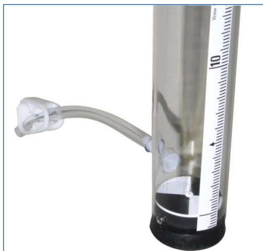
Slika 4. Prikaz menzure i secchi diska za određivanje turbiditeta u laboratoriju [21]
