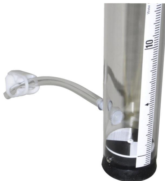
Slika 15. Prikaz secchi diska u menzuri koji se koristi za mjerenje turbiditeta u laboratoriju
