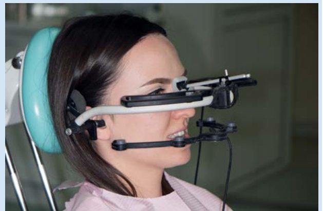
Slika 2. Ultrazvučni uređaj za snimanje kretanja donje čeljusti na temelju šest stupnjeva slobode
