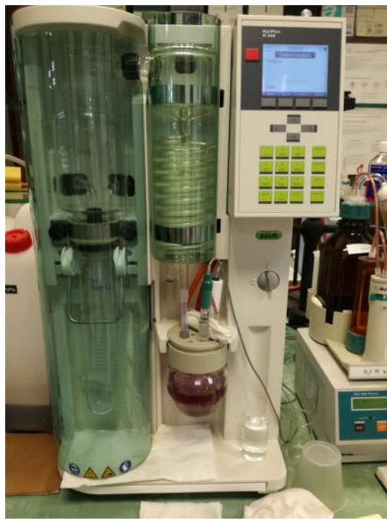
Slika 7. Uredaj za destilaciju i automatsku titraciju KjelFlex K-360
