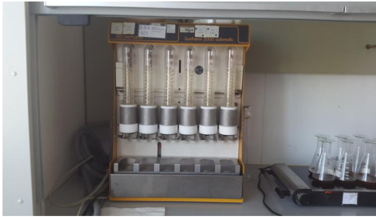
Slika 3.2.1.3. Uređaj za ekstrakciju, Soxtherm 2000 Automatic, Gerhardt
