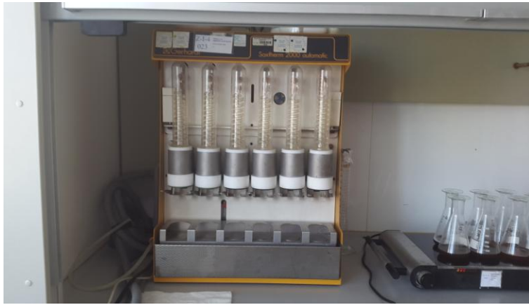
Slika 3.2.1.3. Uređaj za ekstrakciju, Soxtherm 2000 Automatic, Gerhardt
